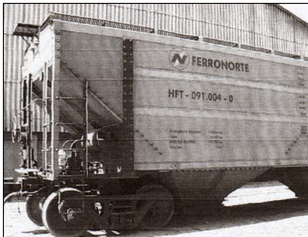
FIGURA 11 - Exemplo de vagão do tipo “hopper”, para granéis sólidos.
