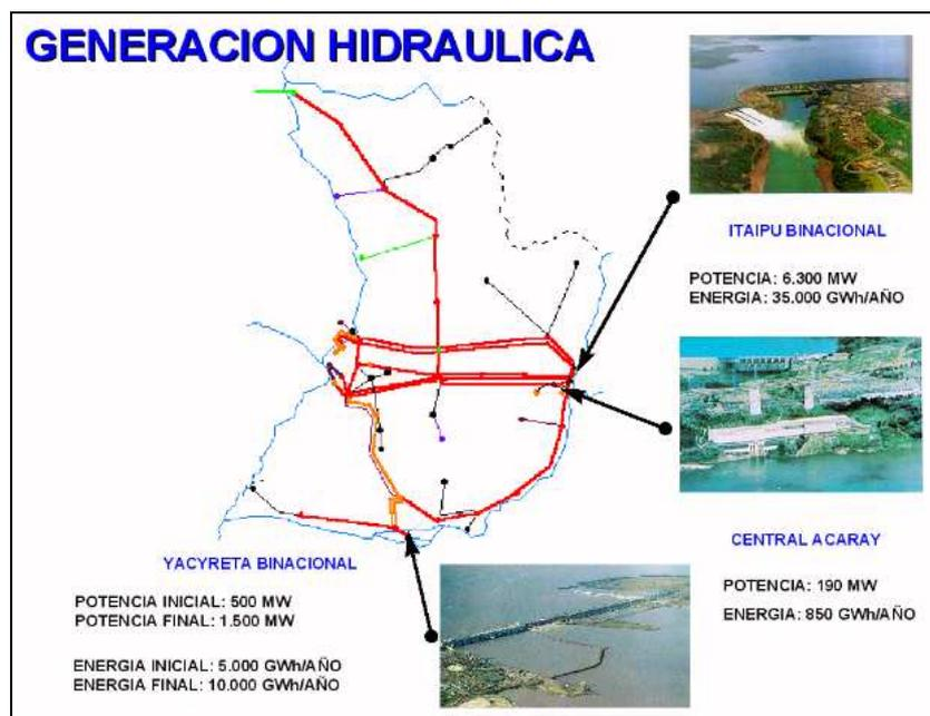
**FIGURA 1 – GERAÇÃO DE ENERGIA ELÉTRICA NO PARAGUAI POR USINAS HIDRELÉTRICAS**
