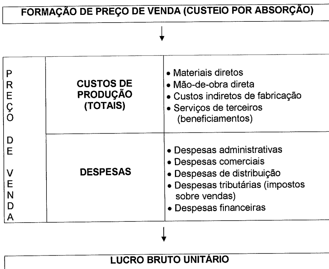
Figura 8 - Modelo estrutural de formação de preço pelo custeio por absorção
